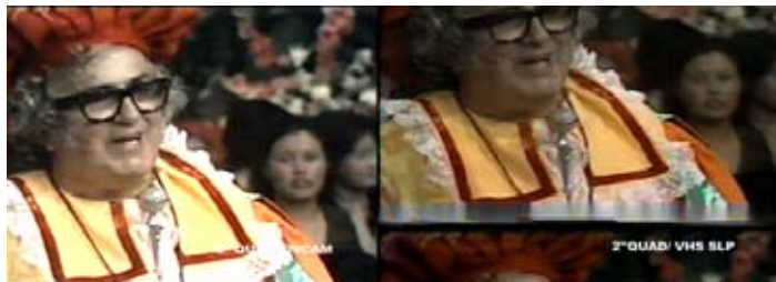
Comparação de imagens digitalizadas a partir de fita 2" Quadruplex feitas em 2008 (à esquerda) e em 1992 (à direita) do programa de Chacrinha na TV Tupi veiculado em 1974.
