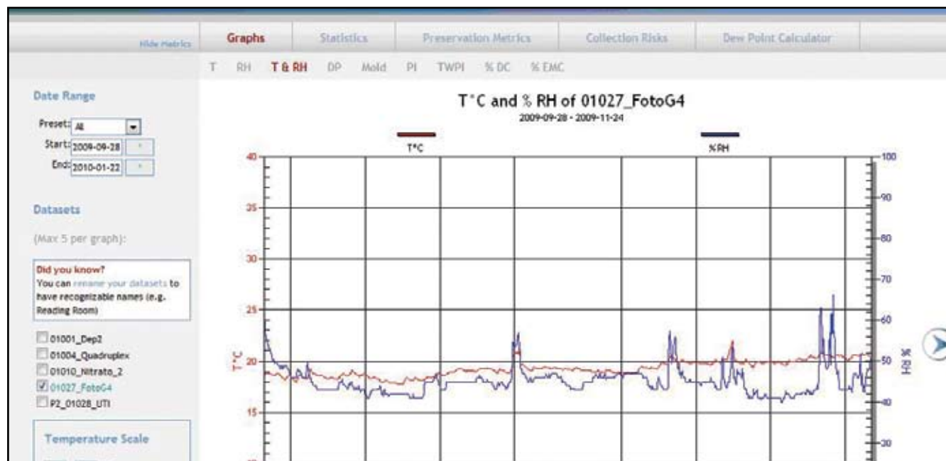
Gráfico que permite analisar os dados lidos pelos aparelhos de monitoramento (Temperatura e Umidade Relativa).
