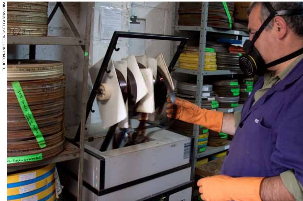
Procedimento de descarte técnico em trituradora de películas.
