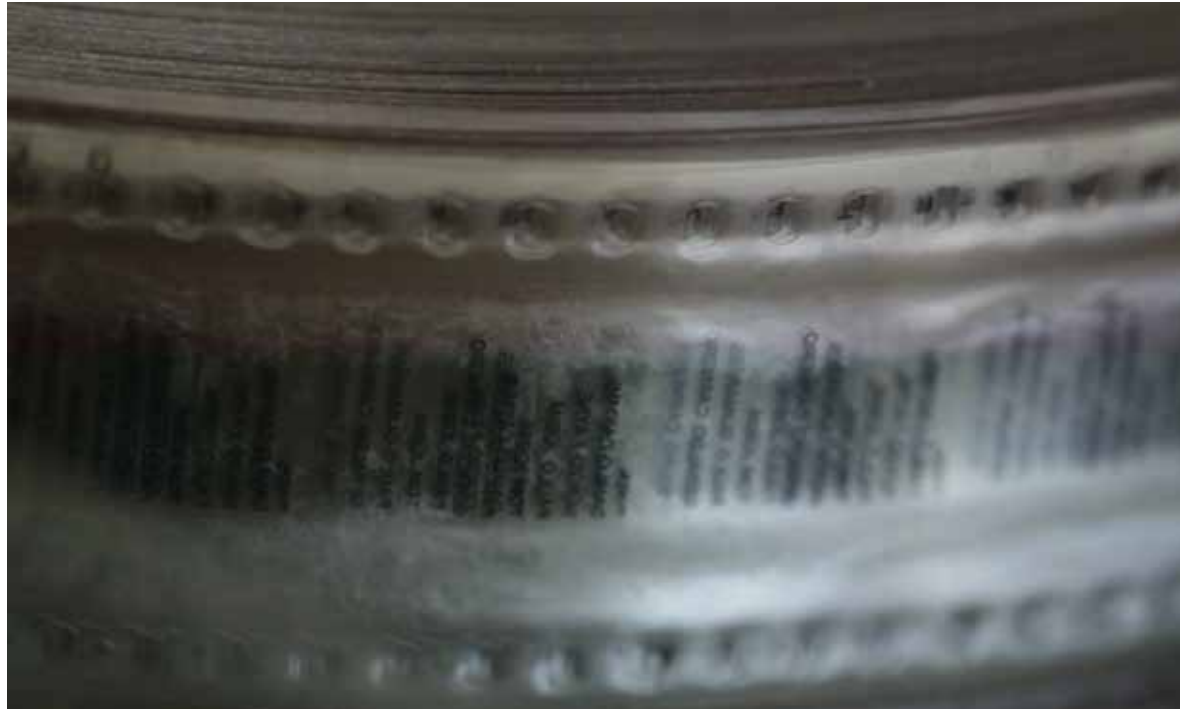
Detalhe de rolo do negativo original de imagem 35mm de Tempo do mar, de Pedro de Moraes (1971): créditos iniciais apresentando encolhimento e cristalização.
