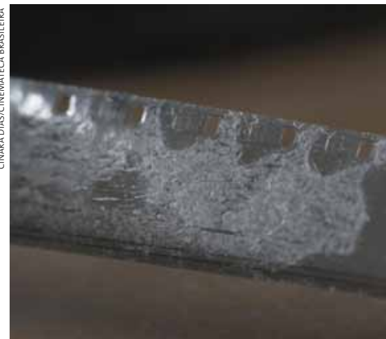
Negativo original de som 16mm de Lacrimosa, de Aloysio Raulino (1970), apresentando cristalização.
