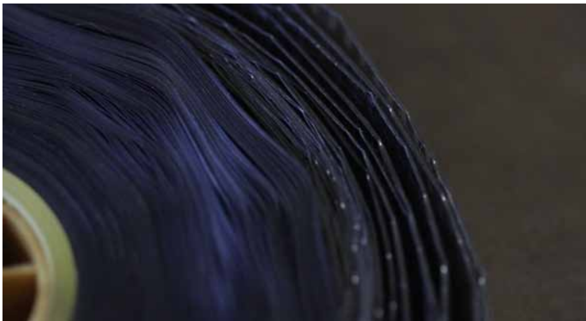
Negativo original de imagem 35mm preto e branco de Adultério à brasileira, apresentando encançamento do suporte, principalmente nas bordas.
