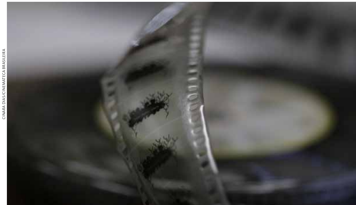
Rolo do negativo original de imagem 35mm de Adultério à brasileira , de Pedro Carlos Rovai (1969), créditos iniciais apresentando abaulamento e encolhimento.
