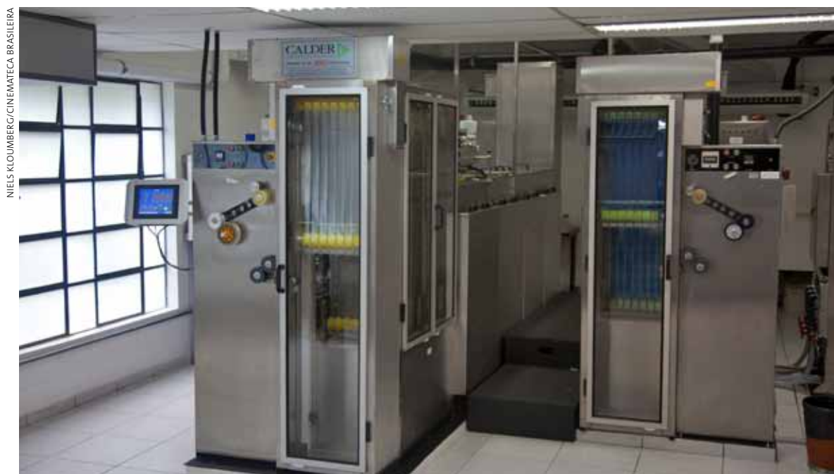
Reveladora Calder colorida, adquirida no âmbito do Programa de Restauro de filmes da Cinemateca.
