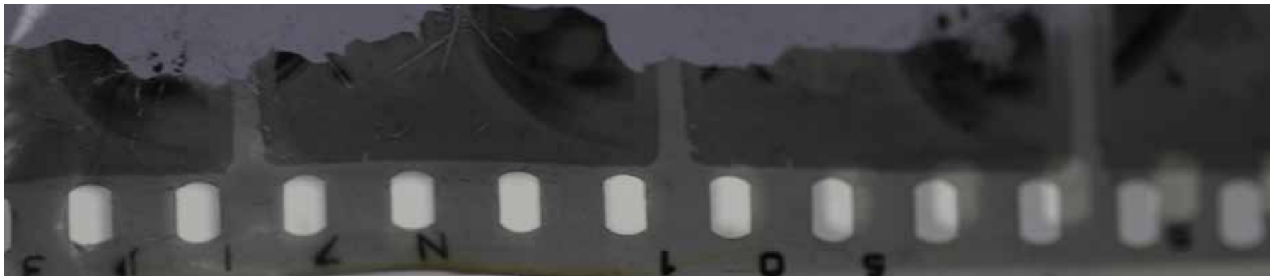
Negativo original de imagem 35mm preto e branco de Adultério à brasileira, apresentando avançado estágio de deterioração e desprendimento da emulsão.
