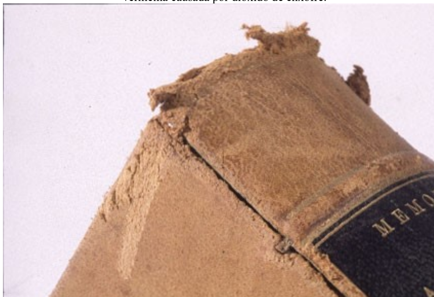
Figure 1.15- Livro coberto com couro curtido vegetal mostra deterioração significativa conhecida como podridão vermelha causada por dióxido de enxofre.
