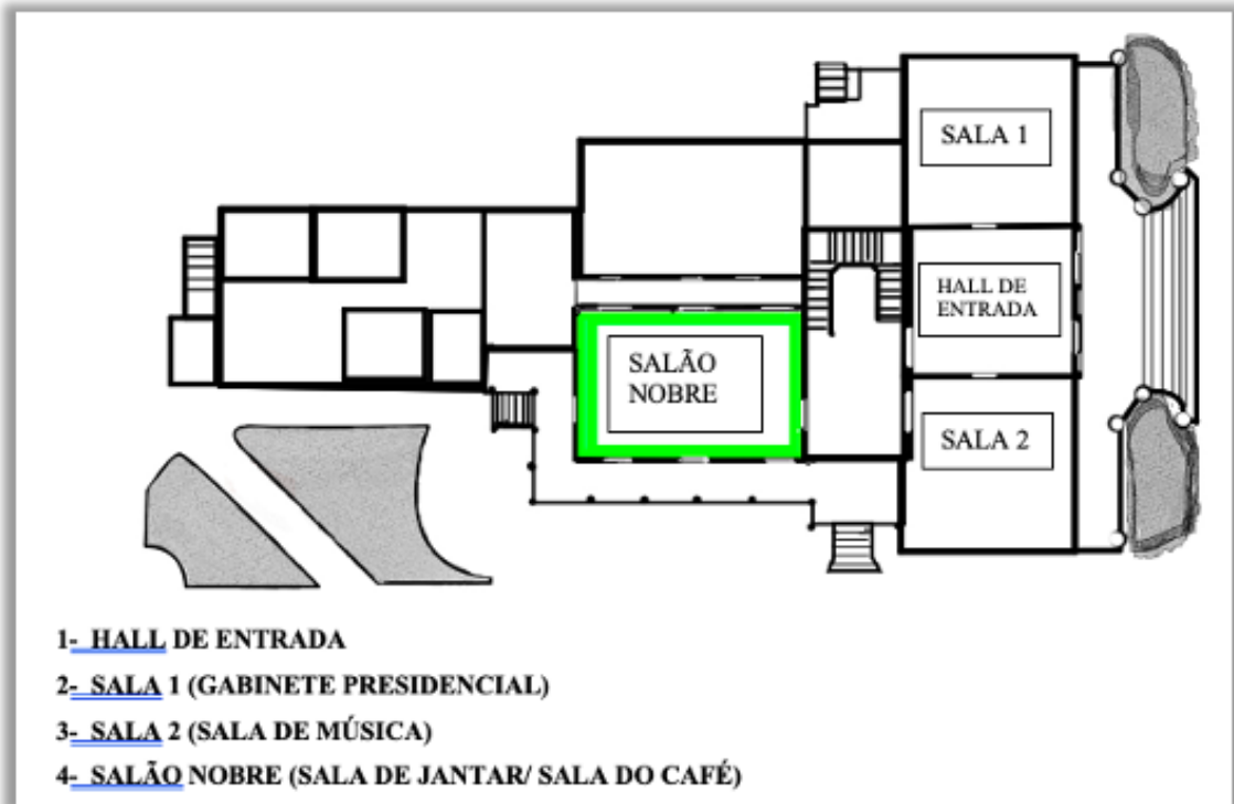
Figura 5: Planta baixa do primeiro pavimento (piso nobre), detalhe da localização do Salão de Jantar, objeto de estudo. Atual planta baixa do segundo pavimento (área privativa)
