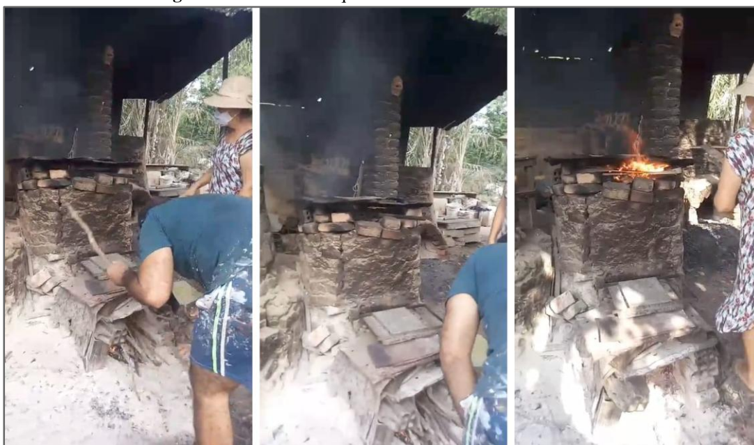
Figura 41: Processo de queima das obras de barro em forno.
