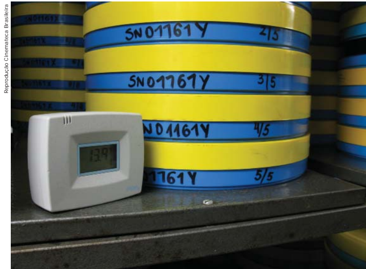
Medidor digital para controle de área climatizada
