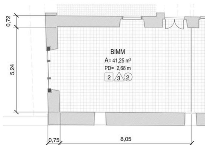
A: área; PD: pé direito;  $\square$ : piso em ladrilho hidráulico;  $\triangle$ : parede com pintura a base de cal;  $\circ$ : teto com forro em madeira tipo “saia e camisa”
